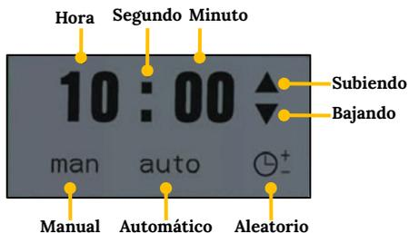
El Pulsador Timer RF Estándar es un pulsador RF (por radiofrecuencia), alimentado por una batería de 3V (CR2430), con frecuencia 433.92MHz y que permite controlar el motor mediante los botones de subida y de bajada manualmente o programar un horario de subida y bajada para temporizar dichas acciones automáticamente
