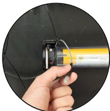
Pulse el botón de ajuste del motor (el motor pita)
