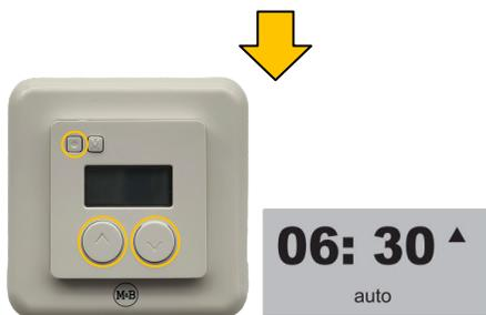
El tiempo de subida del motor se muestra en pantalla. Pulse el **“BOTÓN PARA EL AJUSTE DEL TIEMPO”** para cambiar entre las horas y los minutos y los botones de **“SUBIDA”** y **“BAJADA”** para establecer la hora exacta de subida del motor.
