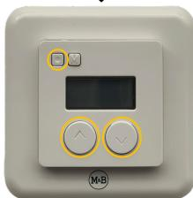
Pulse el “**BOTÓN PARA EL AJUSTE DEL TIEMPO**” para cambiar entre las horas y los minutos y los botones de “**SUBIDA**” y “**BAJADA**” para establecer la hora exacta.
